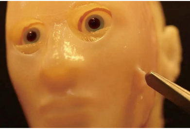
Głowa robota pokryta sztuczną skórą (zdjęcie: Takeuchi i inni)
