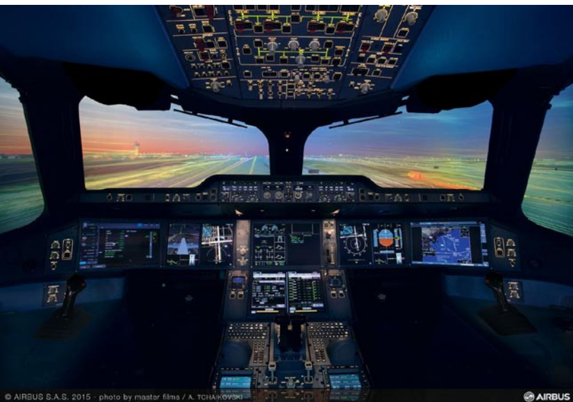
Wskaźniki kokpitu ułożone w kształcie litery T, aby ułatwić zarządzanie samolotem.
